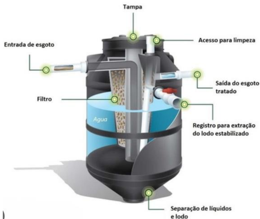
Figura 2 - Modelo esquemático de biodigestor.
