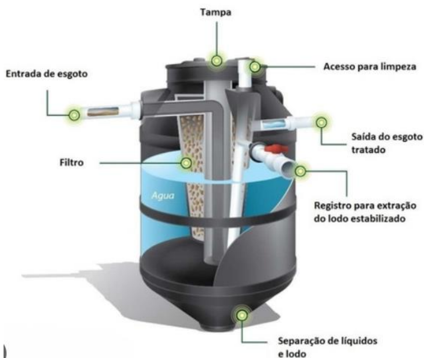
Figura 2 - Modelo esquemático de biodigestor.
